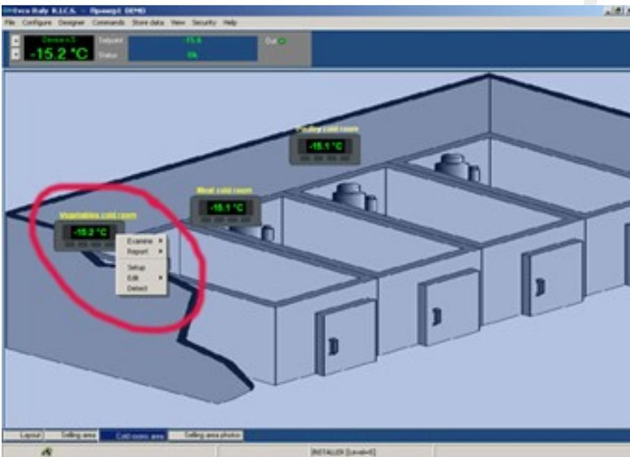
В данной программе каждый прибор имеет свое виртуальное изображение, находящиеся на рабочем поле программы. Виртуальное изображение имеет свой графический вид (можно выбрать свое изображение или оставить изображение по умолчанию), название прибора и один или более дисплеев, на которых отображается значение считываемого реальным прибором параметра. Изображения устройств (далее в тексте будут называться просто «устройства») могут свободно размещаться на рабочее поле программы.
